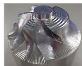
Pęknięcie w trakcie obróbki
